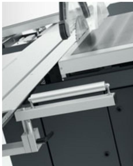
**Rullo di supporto in ingresso.** Il rullo di supporto in ingresso con larghezza 300mm è particolarmente utile quando si tagliano pezzi lunghi contro il registro parallelo. Si ripiega sotto il carrello quando non è utilizzato (lunghezza minima richiesta 3000mm).
