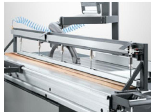
**Barra di pressione pneumatica.** Questa è una soluzione ideale per trattenere saldamente pezzi fino ad 80 mm di spessore, utilizzato in particolare quando si lavora materiale lungo e sottile come l'impiallacciatura. E' composto da due parti controllate separatamente. E' richiesta una linea di collegamento pneumatico a 6 bar.
