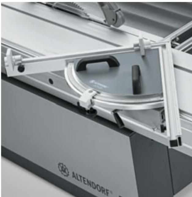
**DUPLEX doppi tagli inclinati.** Il registro DUPLEX rende possibile fare tagli inclinati tra 0 e 90° con velocità e precisione. A 45° è possibile fare tagli in entrambi i lati senza muovere il registro. La misura è regolata tramite lente d'ingrandimento su scala. Tutti i registri DUPLEX possono essere posizionati in ogni punto del carrello.
