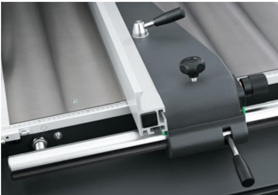
**Registro parallelo con regolazione manuale.** Posizionare il registro manualmente è semplice; la regolazione micrometrica garantisce grande precisione. La barra cromata garantisce scorrevolezza al registro. Il registro può essere ribaltato per liberare il piano quando serve dividere pannelli larghi.
