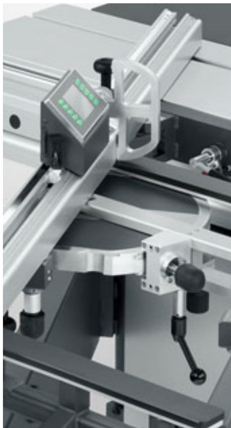
**Registro tagli in squadra inclinabile con DIGIT L.** Per precisione di 1/10 mm quando impostate la lunghezza. Il display visualizza tutte le impostazioni delle battute di misura. L'unità di misura e visualizzazione centrale calibra l'intero sistema in una sola operazione.
