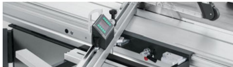
**Registro tagli in squadra inclinabile con DIGIT L.** Per precisione di 1/10mm quando impostate la lunghezza. Il display visualizza tutte le impostazioni delle battute di misura. L'unità di misura e visualizzazione centrale calibra l'intero sistema in una sola operazione.
