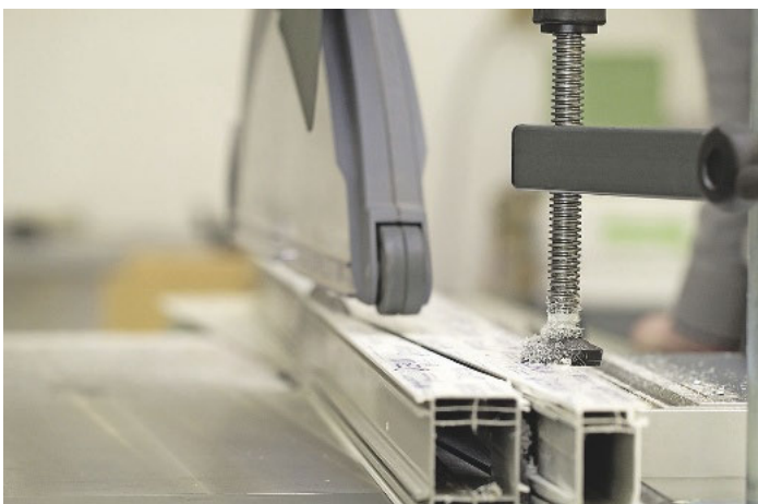
/ Pfiffige Spannvorrichtungen unterstützen und ermöglichen auch sehr knifflige Bearbeitungen, die auf anderen Maschinen kaum durchführbar sind.
