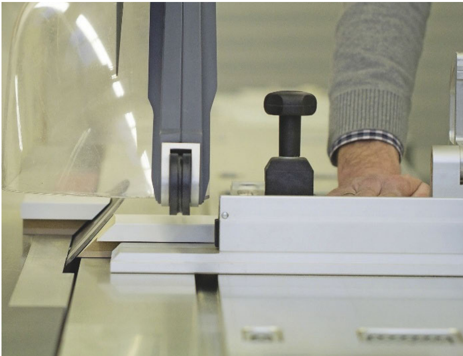
/ Das schwenkbare Sägeblatt. Auf modernen Formatkreissägen erfolgt das Schwenken komfortabel CNC-gesteuert. Nachmessen wird überflüssig, denn der gewählte Winkel wird hochpräzise eingestellt.
