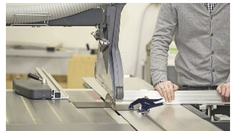
/ Sicher gespannt wird hier schwer zu bearbeitendes Carbonmaterial hochpräzise in Form gebracht.
