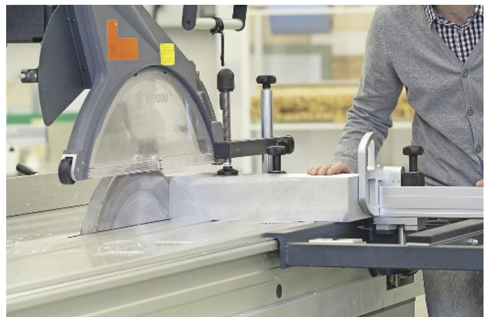
/ Materialvielfalt? Aber klar! Auch Aluminiumplatten und -profile lassen sich hervorragend schneiden – vorausgesetzt, man hat die passende Ausstattung.
